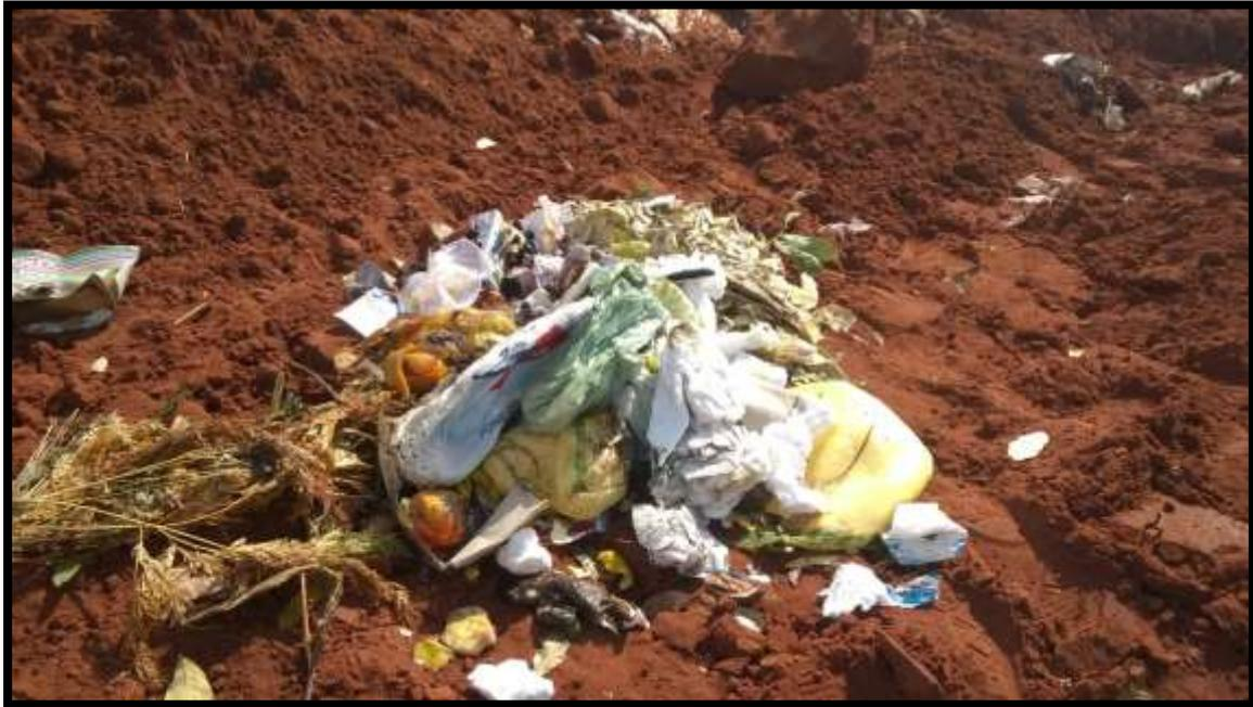
Figura 43 - Separação dos resíduos para análise gravimétrica
